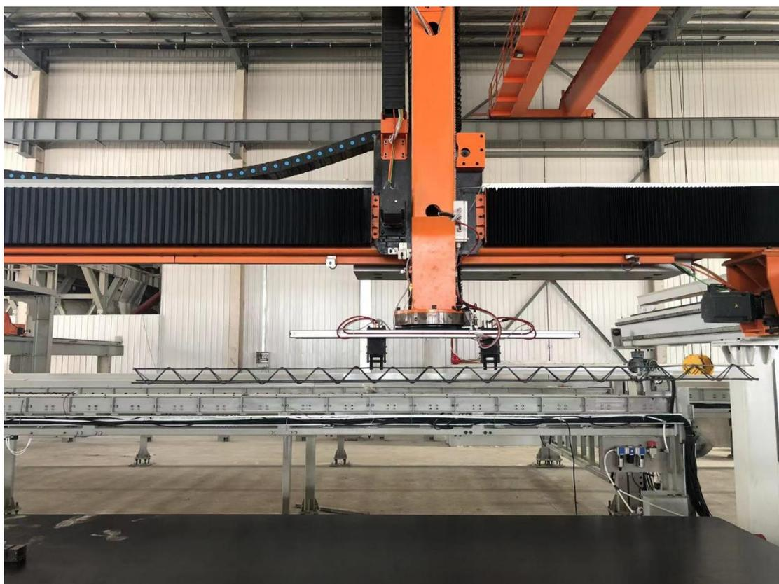
图注 9：装配式建筑预制构件智能生产线
