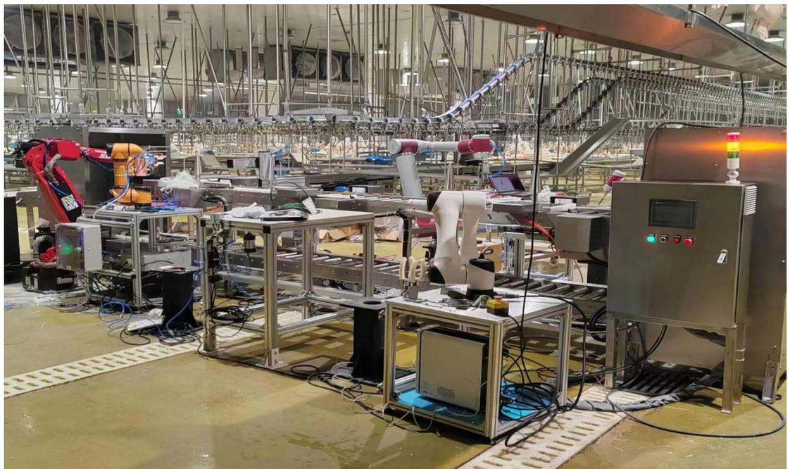
图注 4： 畜禽类肉品高效精准机器人自主分割系统
