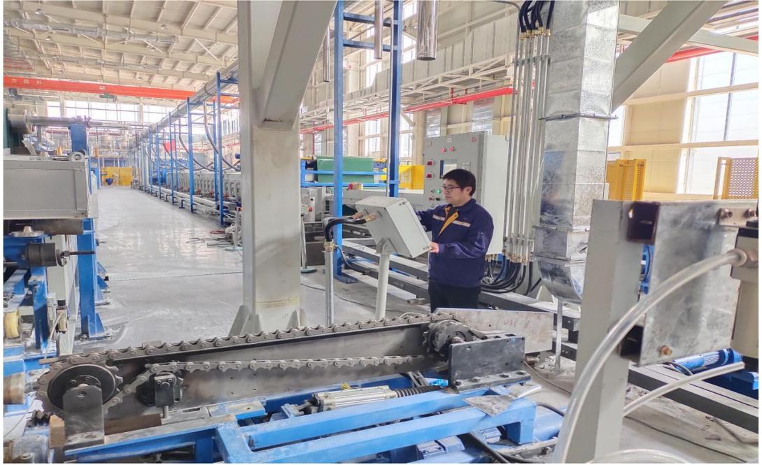
图注 5：气凝胶智能化生产线
